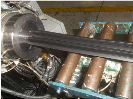
Die folgenden Fotos zeigen die Doppelstrangextrusion von zwei Elastomerprofilen für Spezialdichtungen. Deutlich ist der Quellvorgang nach der Düse zu erkennen. Der Aufbau der Prallplattenwerkzeuge für diese Extrusionsprofile zeigt auch bei hohen Geschwindigkeitsunterschieden ein großes Fenster an akzeptierbaren Verarbeitungsbandbreiten. Hierdurch kann
