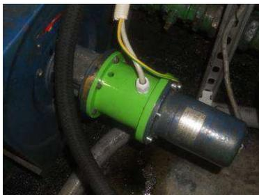
Genauigkeit zu kommen, wurde auf der Motorwelle parallel zu der (mit dem alten Gleichstrommaschinen-Umrichter verwurzelten) analogen Tachomaschine ein HENSCHEL-Nachrüst-Modul mit einem digitalen
